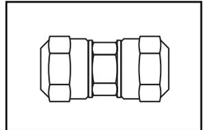
QUICK JOINT FOR COPPER OR PLASTIC TUBING (CTS) BOTH ENDS
