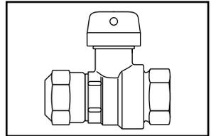
QUICK JOINT FOR COPPER OR PLASTIC TUBING (CTS) INLET BY FEMALE IRON PIPE THREAD OUTLET
