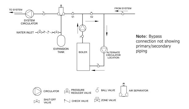
Figure 5 - Single Zone System With DHW Priority
